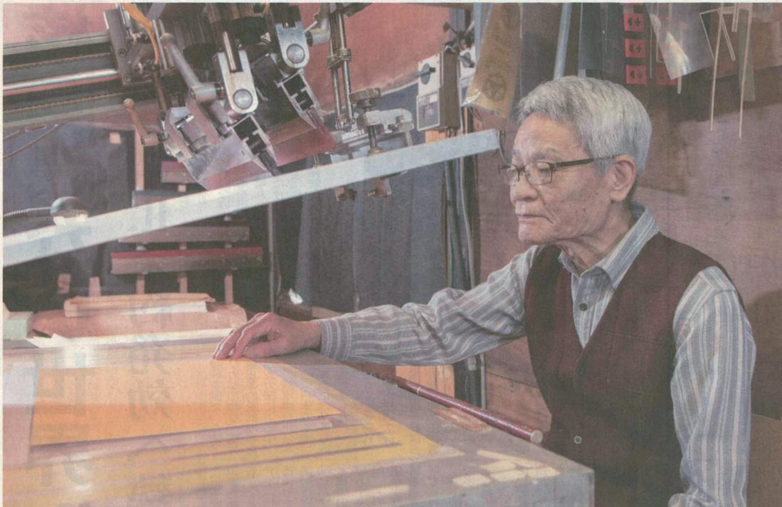
印刷する材料をセットすると、原版が降りてきて、スクイジーがゆっくりとインキを刷り込みます
